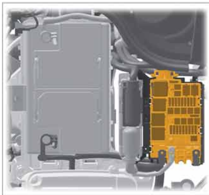
Elektrikbox im Motorraum links neben der Batterie
